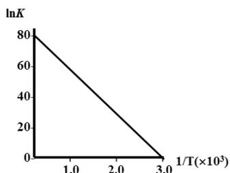
已知自由能關係式  $\Delta G^\circ = \Delta H^\circ - T\Delta S^\circ$ ,  $\Delta G^\circ = -RT \ln K$ 。若以平衡常數  $\ln K$  vs.  $1/T (\times 10^3)$  作圖得到上圖，試計算出  $T$ 、 $K$ 、 $\Delta H^\circ$  及  $\Delta S^\circ$ ，請問下列敘述何者為真？( $R = 8.314 \text{ J/K} \cdot \text{mol}$ )
